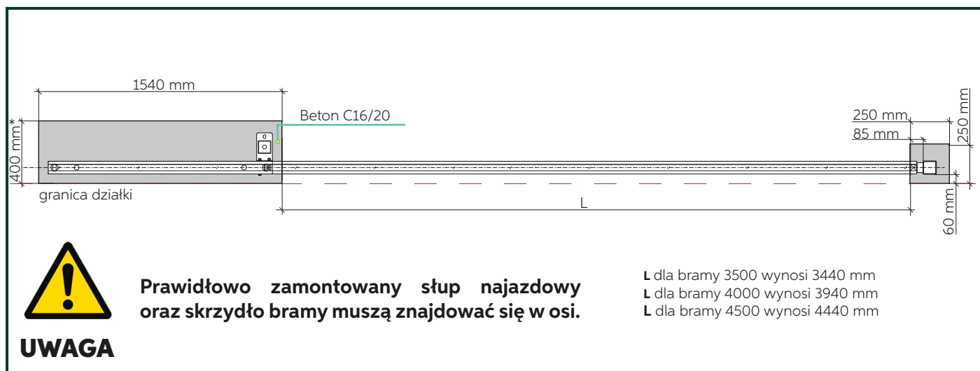
RYS. 2 PRZEKRÓJ BLOKU FUNDAMENTOWEGO
